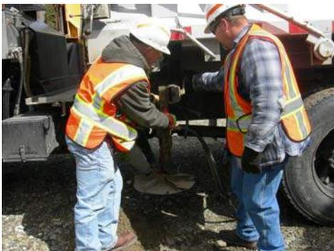
5) If necessary, install the spinner.
